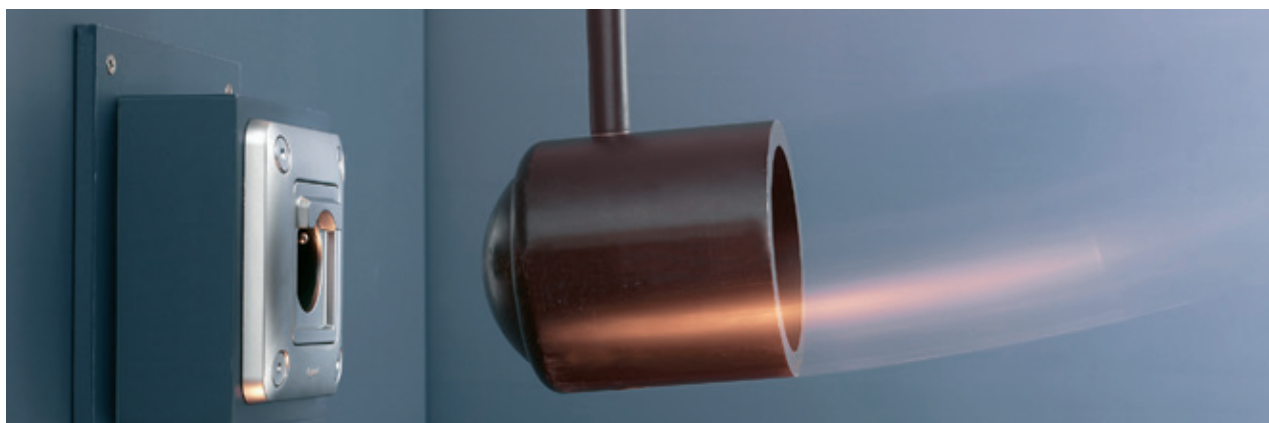
IK 10 : RÉSISTANCE AUX CHOCS MAXIMALE | Tous les produits résistent à des chocs de 20 joules
